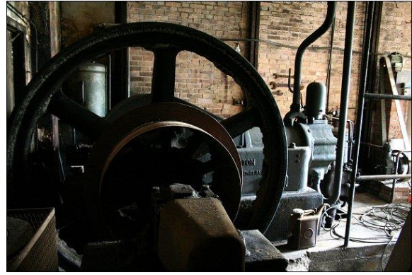
Un moteur diesel monocylindre horizontal de marque Ruston et Hornsby fabriqué à Lincoln (Angleterre) dans les années 1930
